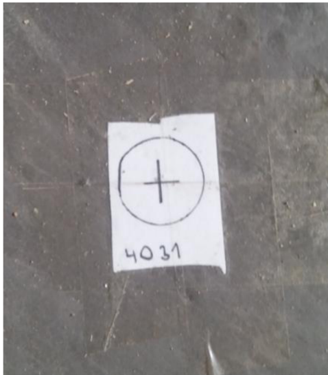
Obr. 5 Stabilizace – papírový štítek
