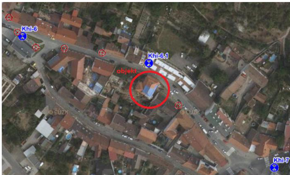
Obr. 4 Bodové pole [zdroj podkladu: cuzk.cz]
