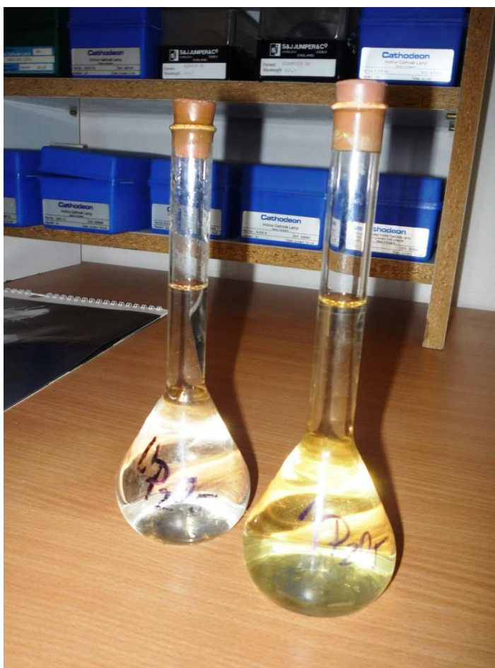
Obrázek 14: Napravo je baňka se vzorkem obsahující fosfát po přidavku vybarvovacího roztoku, kde došlo k vytvoření žlutého zbarvení. Nalevo je baňka se vzorkem neobsahující fosfát, po přidání vybarvovacího roztoku zůstává bez zbarvení.
