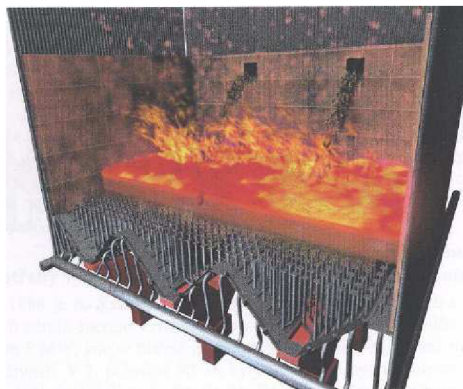
Obr. 2.5 Kotel se spalováním ve fluidní stacionární vrstvě [2]
