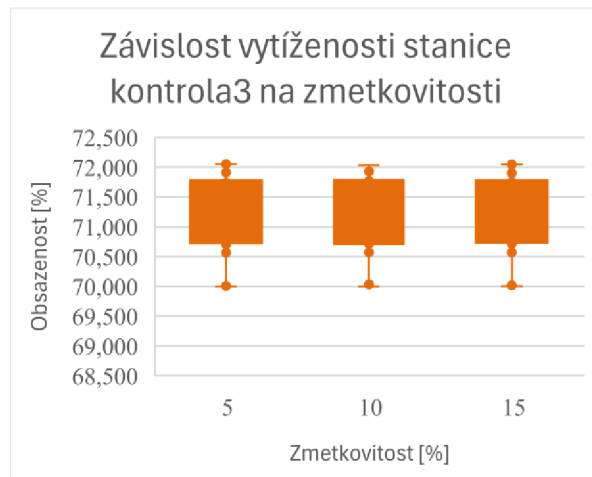
Obr. 16 Závislost vytíženosti stanice kontrola3 na zmetkovitosti
