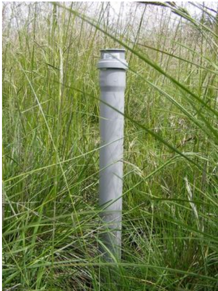
Obr. č. 19 Plastová trubka pro měření výšky hladiny vody 06/2010 Foto D. Papáčková
