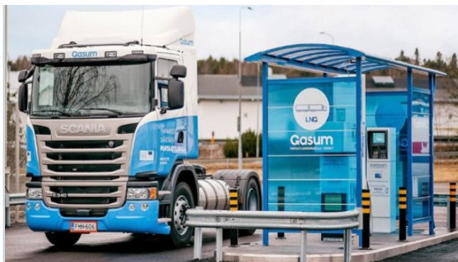
Obr. 3.8 Plnicí stanice a tahač na LNG
