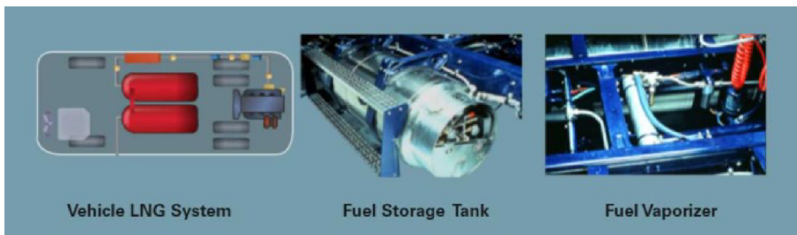
Obr. 3.6 Systém LNG ve vozidle
