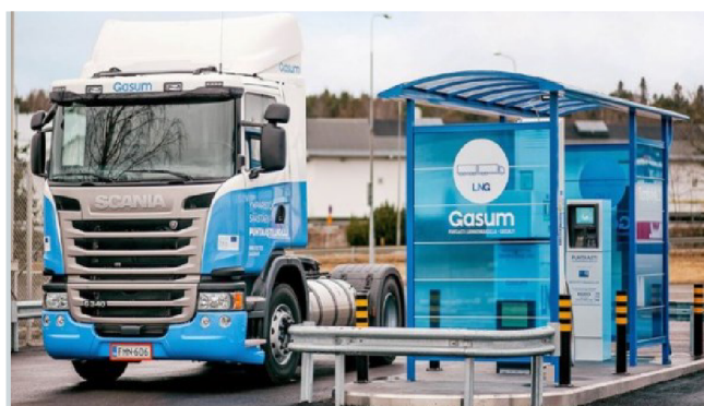
Obr. 3.8 Plnicí stanice a tahač na LNG
