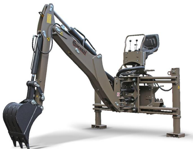
Obr. 4 Podkop s ramenem posuvným po rámu [3]
