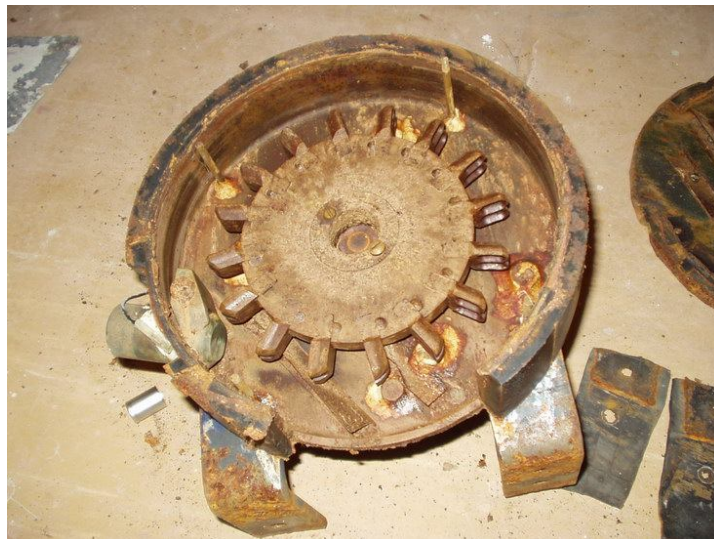
Obr. 5.15 Peltonova turbína s jednou tryskou
