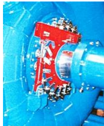
Obr. 5.3 Vnější regulace rozváděcích lopatek
