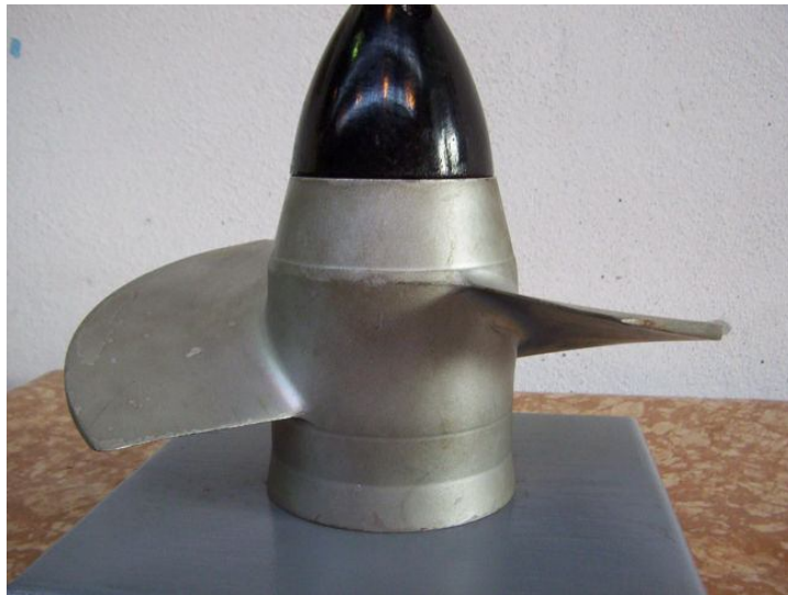
Obr. 4.10 Oběžné kolo vírové turbíny
