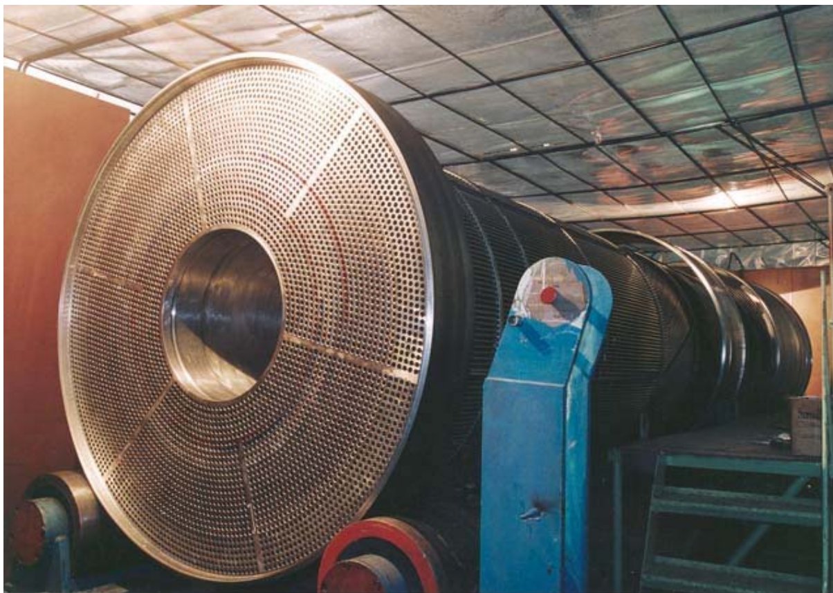
(Nahoře) Obr. 8. Montáž mezivýměníku reaktoru BN-800 [9]
