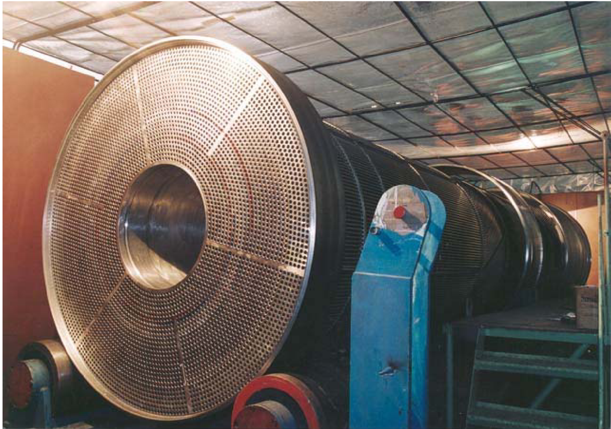
(Nahoře) Obr. 8. Montáž mezivýměníku reaktoru BN-800 [9]
