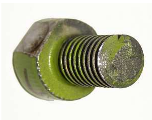
Obr.8) Detail lomu na šroubu č.1
