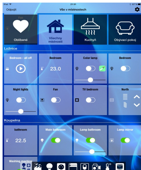
Obr. 2. Příklad vizuálního rozhraní, realizovaného aplikací iFoxytrot.
