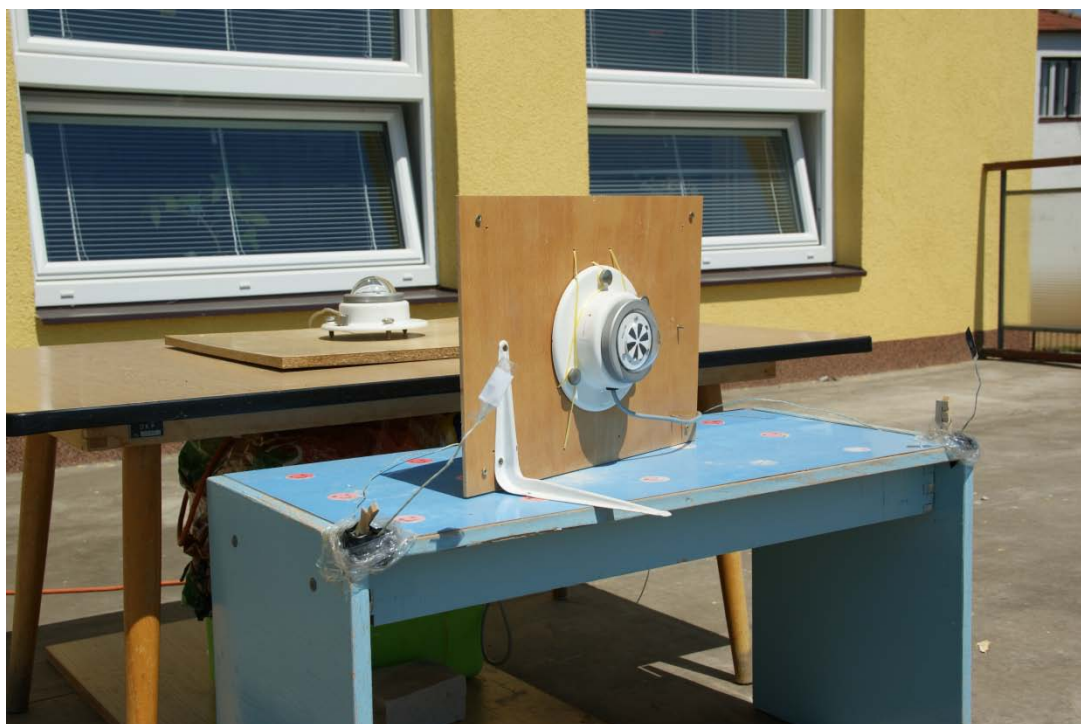
Obrázek 29: Měřicí sestava (zde je jeden pyranometr umístěn do polohy pro měření svislé sluneční radiace a druhý pro měření vodorovné sluneční radiace)
