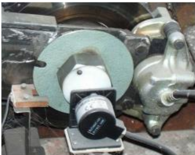
Obrázek 21, Inkrementální snímač otáček [3]
