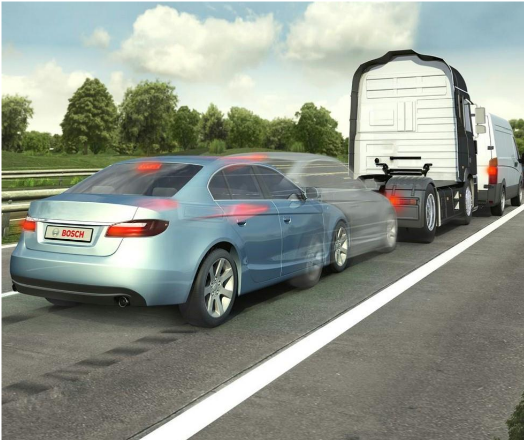
Obrázek 11, Systém prediktivního nouzového brzdění [25]
