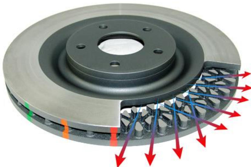
Obrázek 3, Kotouč brzdy s vnitřním chlazením [22]
