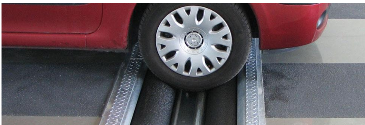
Obrázek 15, Test brzd na válcové zkušebně [23]
