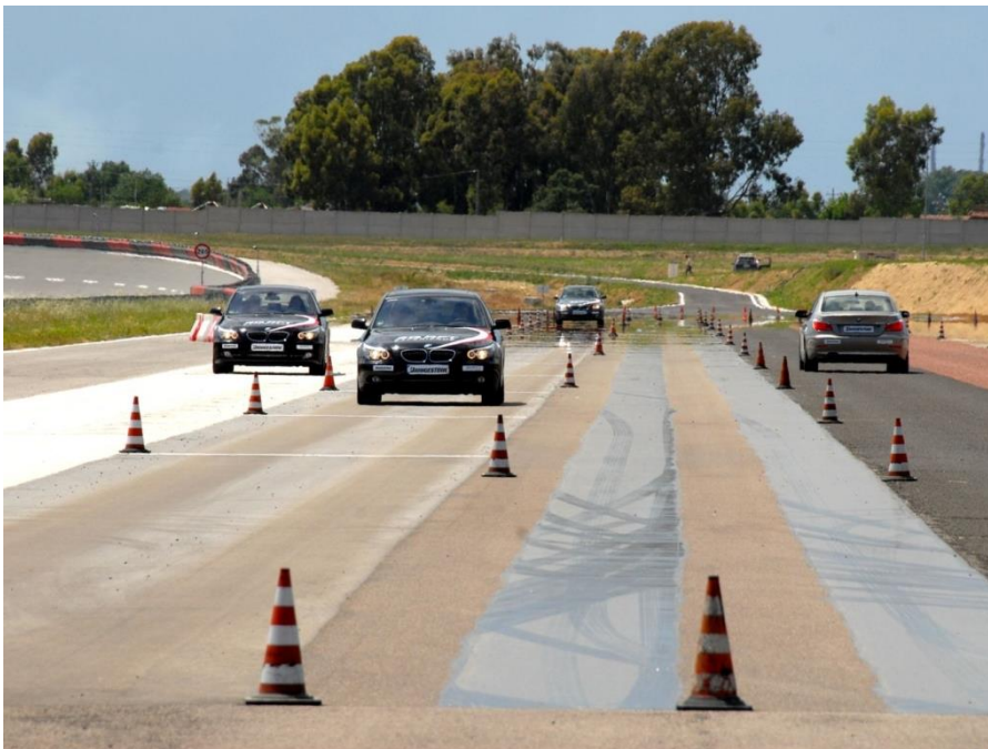
Obrázek 12, Asfaltová plocha pro dynamické zkoušky brzdění [17]
