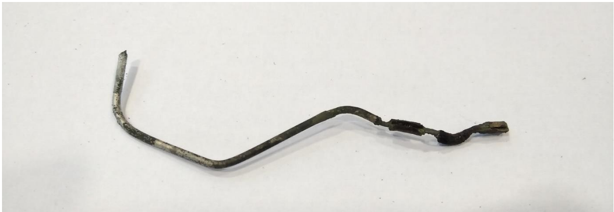
Obr. 60 Zkorodovaný Inconelový drátek.
