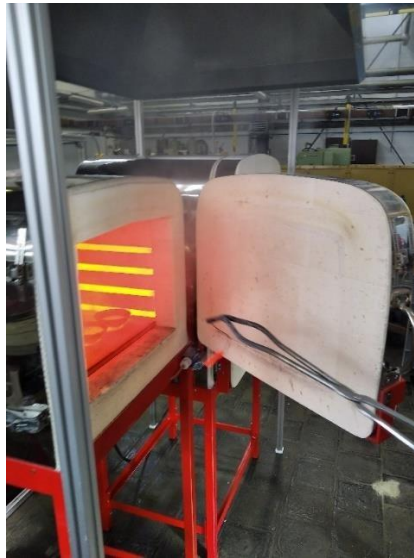
Obr. 39 Moment, kdy dochází k vytahování horkého vzorku z pece.
