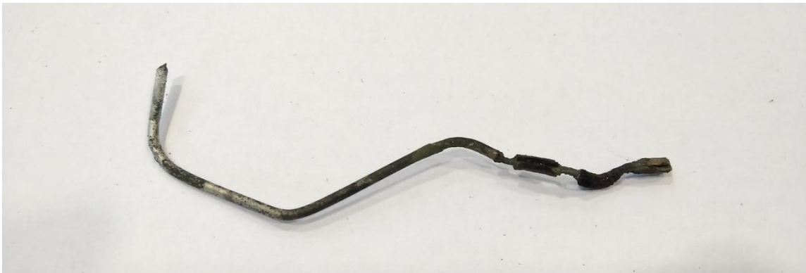
Obr. 45 Zkorodovaný Inconelový drátek.
