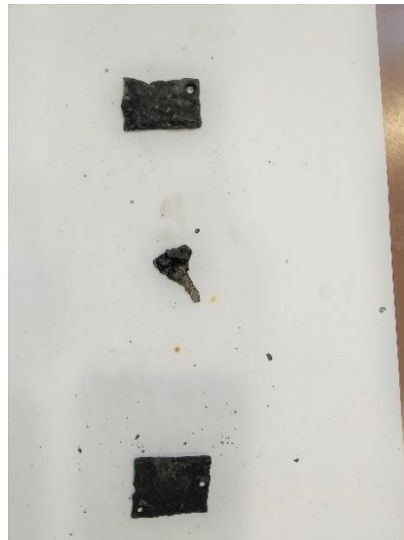
Obr. 38 Rozpadlý vzorek, po posledním měření.
