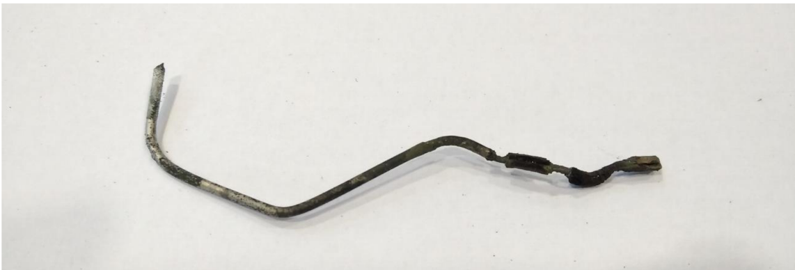
Obr. 45 Zkorodovaný Inconelový drátek.
