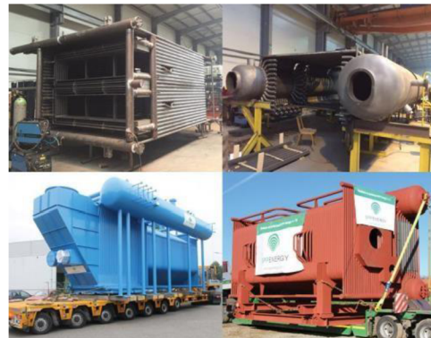
Obr. 9 Ukázka finálních produktů, tvořených z hadovitých trubkových systémů, oblouků a dalších komponent [1].
