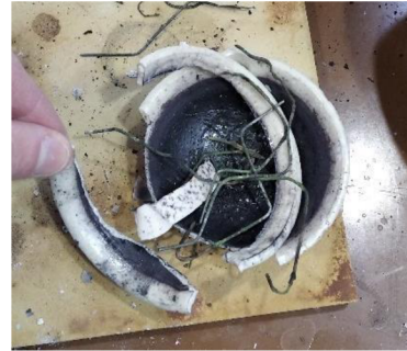
Obr. 11 Popraskaná tavičí miska tenkostěnná.
