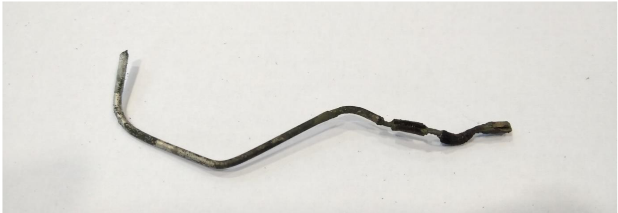
Obr. 60 Zkorodovaný Inconelový drátek.
