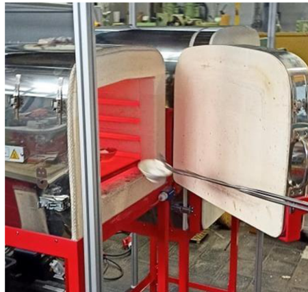
Obr. 12 Okamžik, kdy je miska s nerozpuštěnou solí vkládána do pece.
