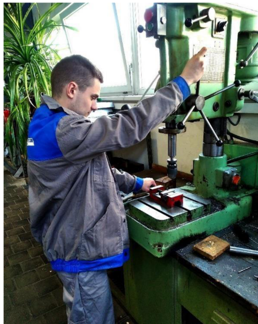
Obr. 21 Příprava vzorku na stolní vrtačce.
