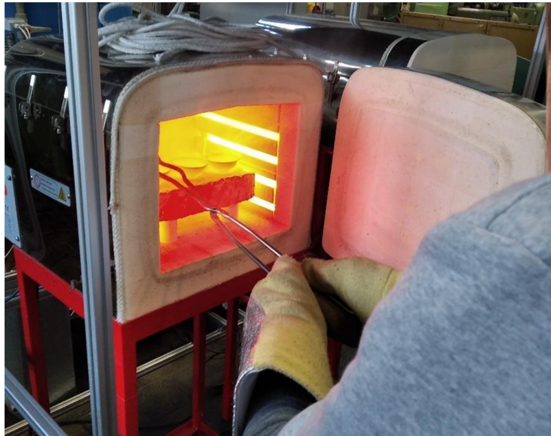
Obr. 29 Způsob uspořádání misek, cihly a válečků v peci.
