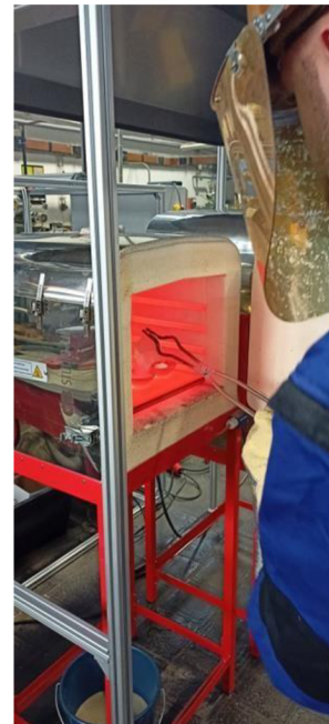
Obr. 43 Moment, jak je sůl dosypávána do misek v peci.
