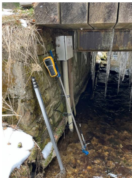
obr. 10: lať, přístroj FlowTracker 2 a hladinoměr ALA typ 4020 (Jan Vacek, 2023)
