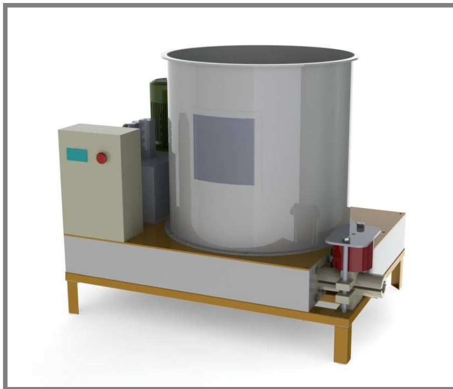
Obr. 6-39 Sestava briketovacího lisu
