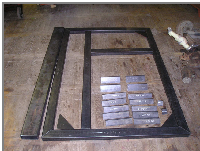
Obr. 6-40 Díly základního rámu
