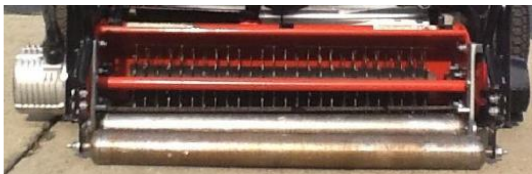
Obr. 28 Záměna žacího vřetene za vertikutační jednotku
