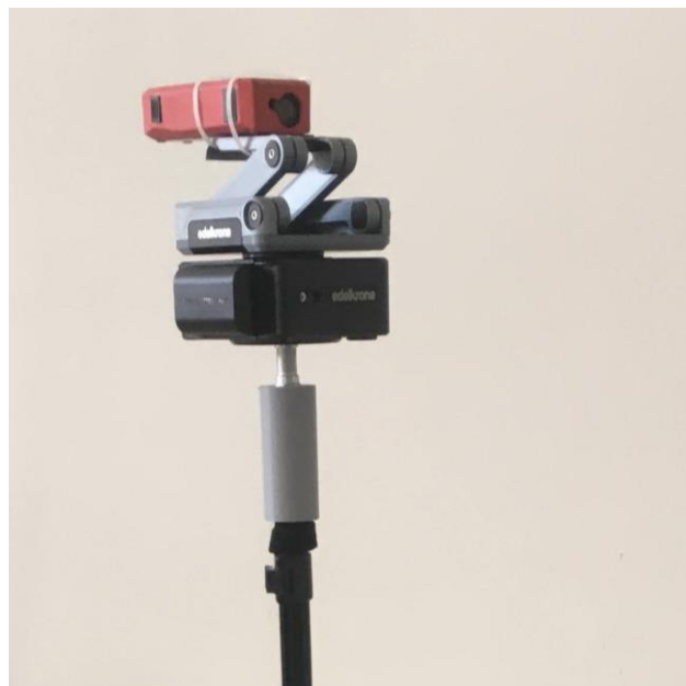
Obrázek 7.6 Stativ s rotátorem a laserovým dálkoměrem
