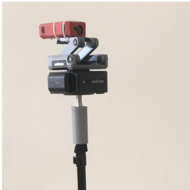
Obrázek 7.6 Stativ s rotátorem a laserovým dálkoměrem
