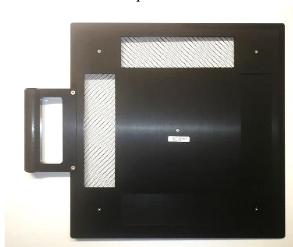
Obrázek 6.2 Filtr slunečního simulátoru s označením 700 \text{ W/m}^2
