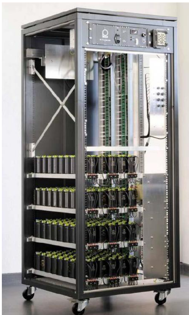
Obrázek 4.2 Záblesková generátor Pasan SunSim 3c [16]
