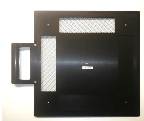
Obrázek 6.2 Filtr slunečního simulátoru s označením 700 \text{ W/m}^2
