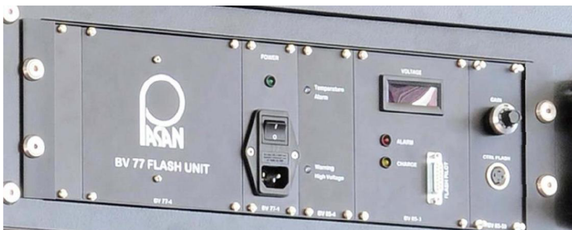
Obrázek 4.3 Elektronické zásuvné karty zábleskového generátoru Pasan SunSim 3c [16]
