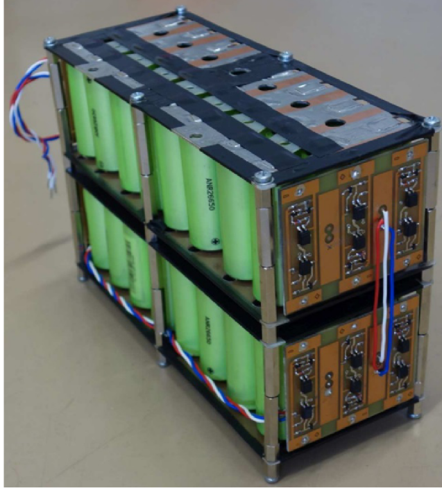
Obr. 2.1: Fotografie hotové baterie s BMS obvody, převzato z [9].
