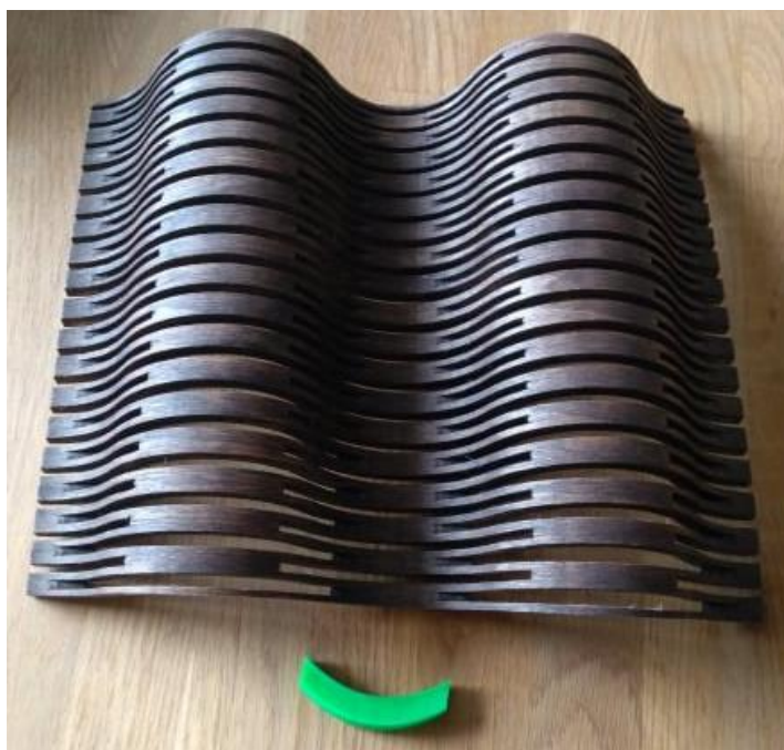
Obrázek 13 Materiál CORFLEX a fixační prvek, Zdroj: Archiv MateriÓ - materiálové karty.
