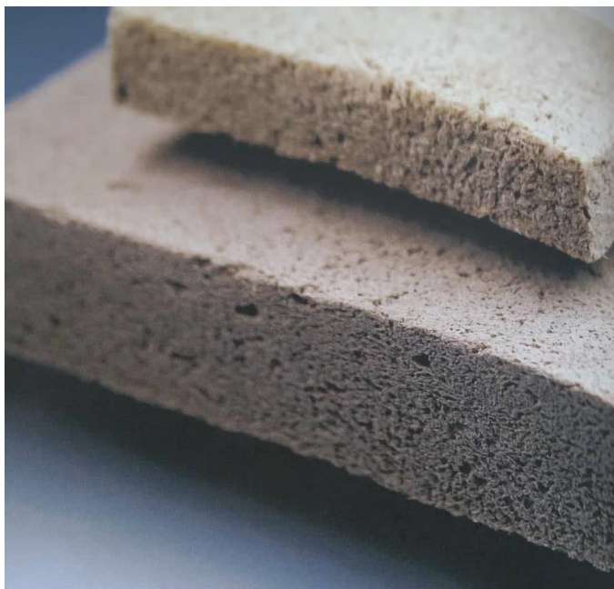
Obrázek 11 Wood Foam – Struktura, Zdroj: Archiv MateriÓ - materiálové karty.
