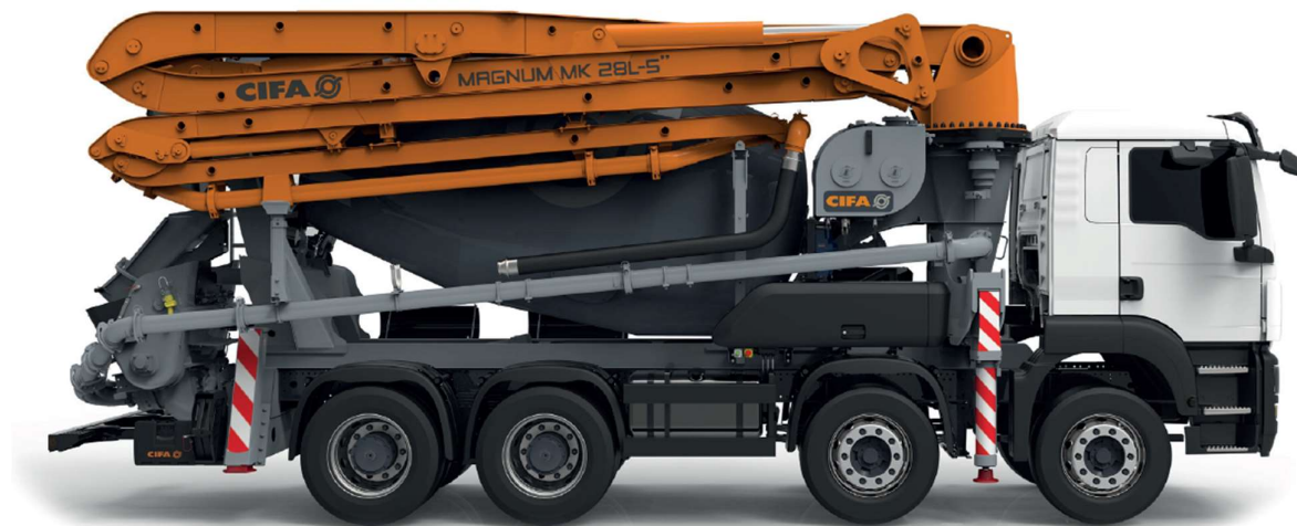
Obr. č. 27 – Domíchávač s čerpadlem
