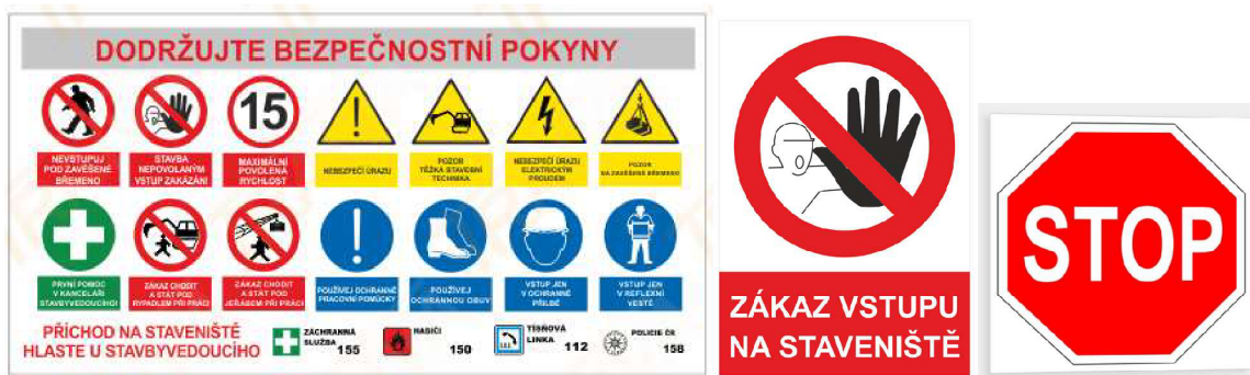
Obr. č. 15 – Bezpečnostní značení u vjezdu na staveniště
