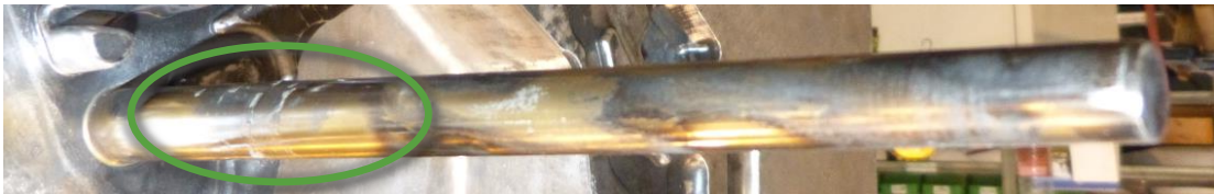
Obr. 40 Stav jádra posice 8.10 po 9 500 cyklech označení – velmi silné erozivní opotřebení a nalepená hliníková slitina
