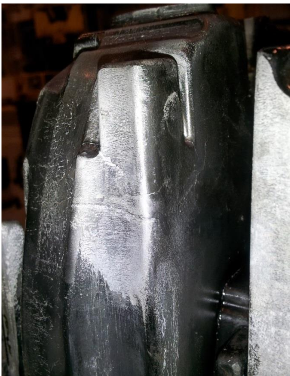
Obr.13 Síťové trhliny a nalepený hliník na licí formě
