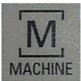
MACHINE – návrat zpět do základní obrazovky stroje, ze všech oken
