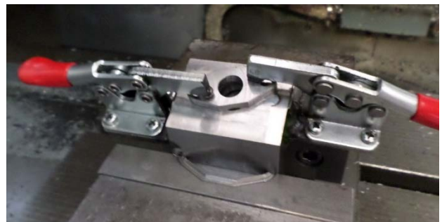
Obr. 12.8 a) upínací kostka (operace 5), b) upnutí polotovaru při poslední operaci (5. operace).
