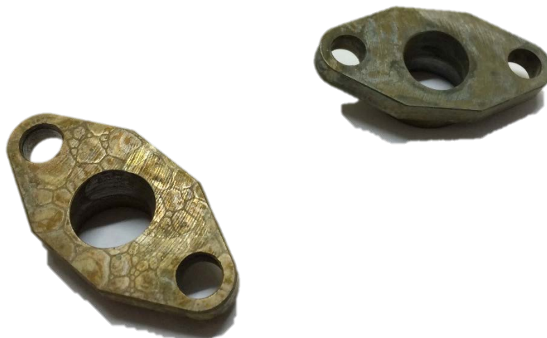
Obr. 14.2 Vadné kusy (koroze).
