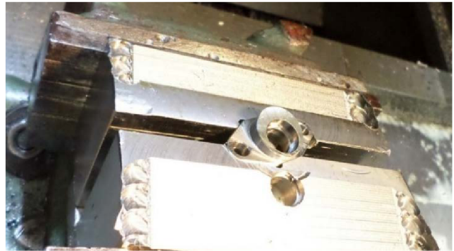
Obr. 12.7 a) přípravek pro ustavení příruby (operace 4), b) upnutí polotovaru při čtvrté.
