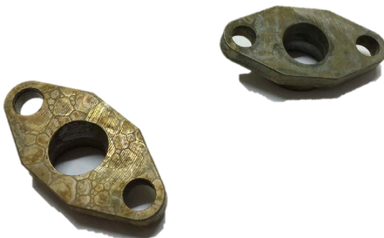
Obr. 14.2 Vadné kusy (koroze).
