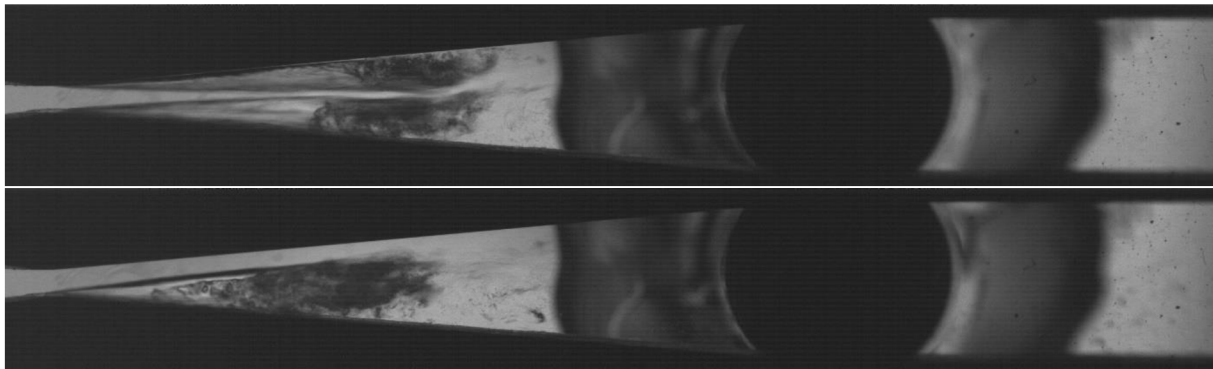
Obr. 4.34 – Vizualizace proudění při stejném kavitačním čísle
