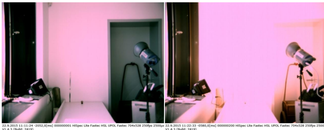
Obr. 12, 13: Expoziční doba 2500 \mu s: vlevo denní osvětlení v místnosti vpravo umělé osvětlení (halogenové žárovky 2 \times 250 W, 1 \times 1500 W).
