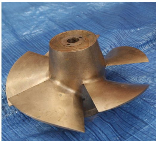
Obr. 2.14: Oběžné kolo vírové turbíny, převzato z [21]
