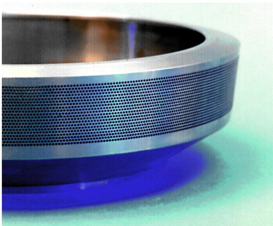
Obr. 2.1 Zvlákňovací hlava na výrobu skleněných vláken; 25 600 otvorů o průměru 0,55 mm [25]
