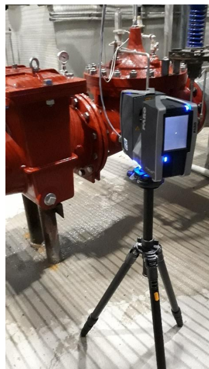
Obrázek 4: Laserový skener Faro Focus 3D S120
