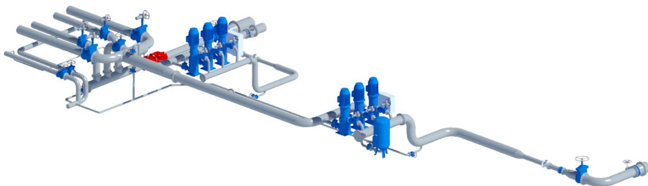
Obrázek 3: Ukázka části BIM modelu vodárny Líšeň
