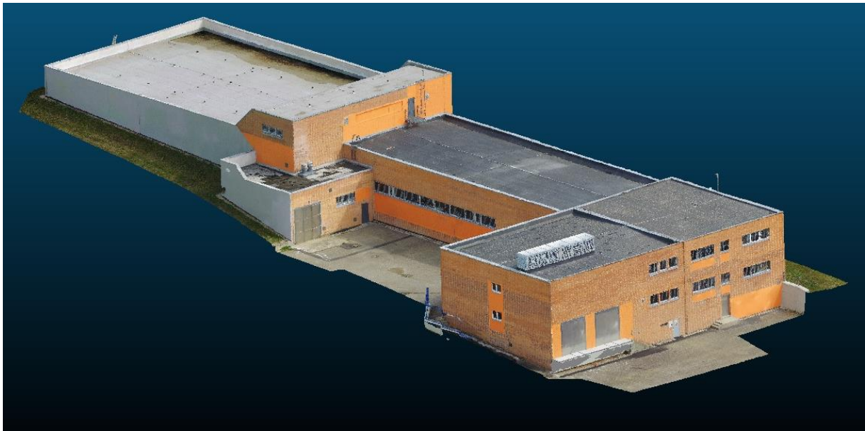
Obrázek 27: Mračno bodů vyhotovené pomocí fotogrammetrie
