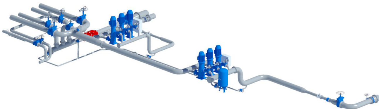
Obrázek 3: Ukázka části BIM modelu vodárny Líšeň
