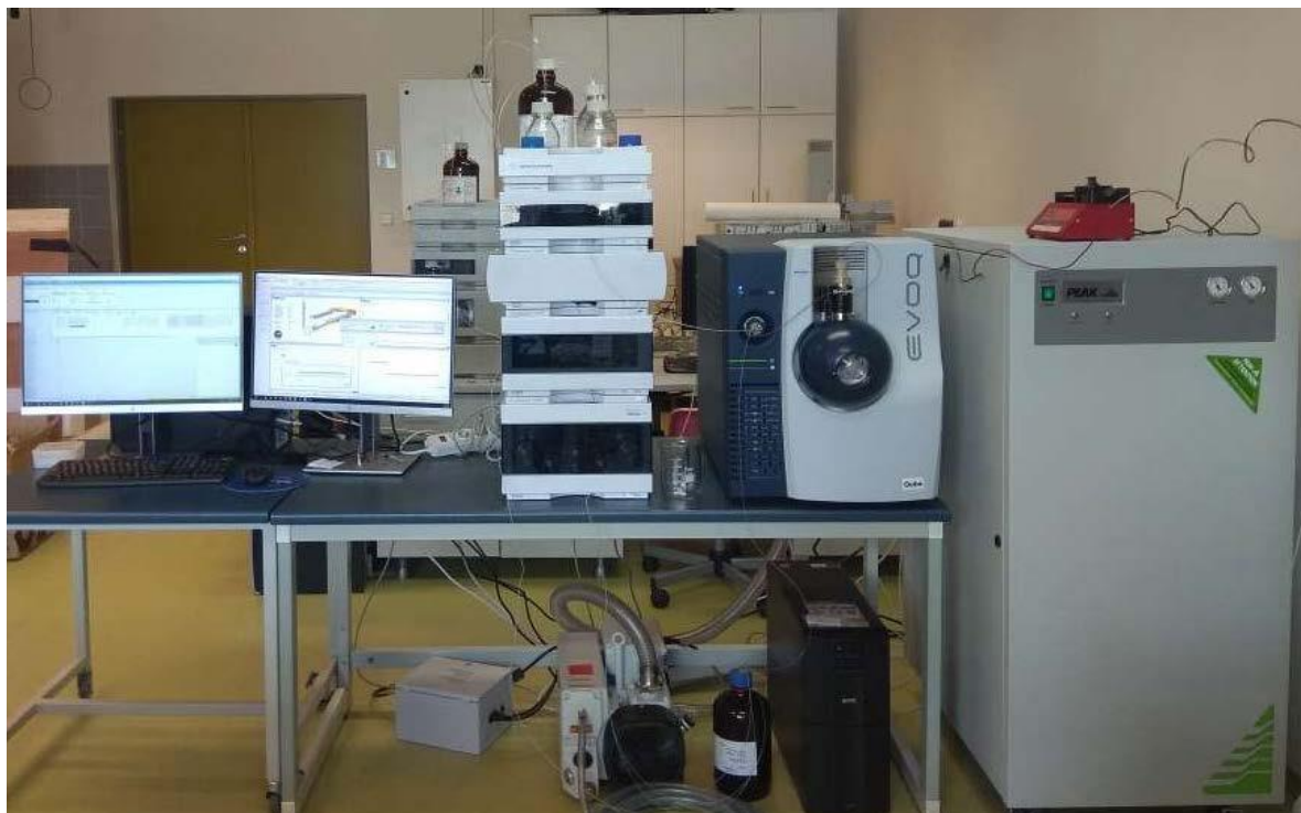
Obrázek 11: Kapalinový chromatograf Agilent 1290 Infinity a hmotnostní spektrometr Bruker EVOQ LC-TQ
