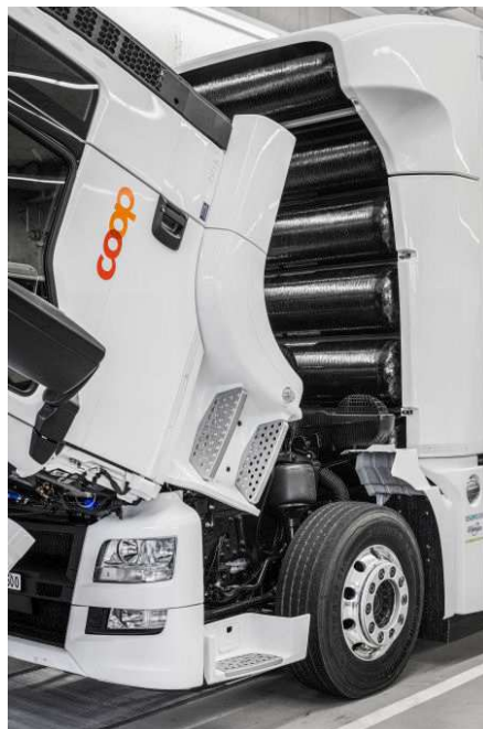
Obr. 2.5 Detailní pohled na vodíkové nádrže
