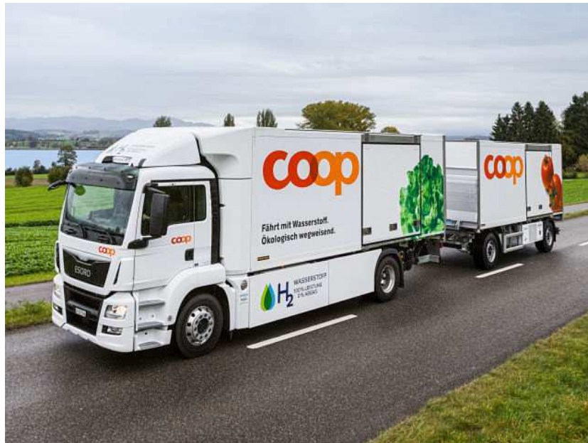
Obr. 2.4 Nákladní automobil MAN poháněný kombinací vodíkového motoru a elektromotoru
