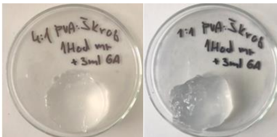
Obrázek 12: PVA hydrogely s daným poměrem škrobu a 1 hodinou mražení s přidavkem 3 ml GA
