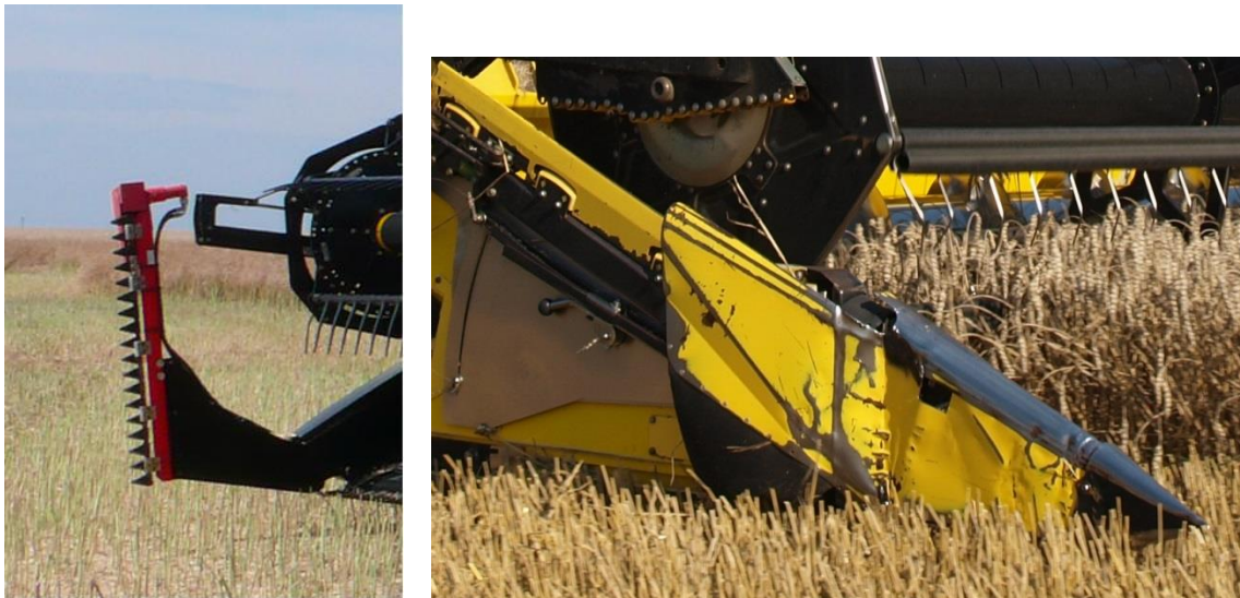
Obrázek 8: Aktivní a pasivní děliče porostu (autor, 2014)
