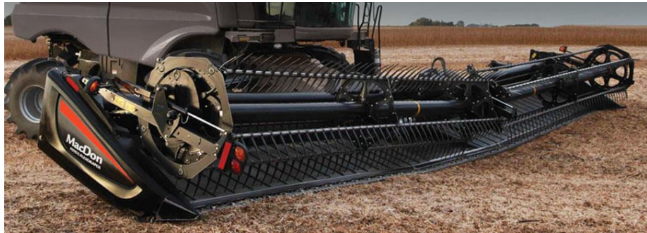
Obrázek 15: Flexibilní sklízecí ústrojí MacDon (macdon.com)
