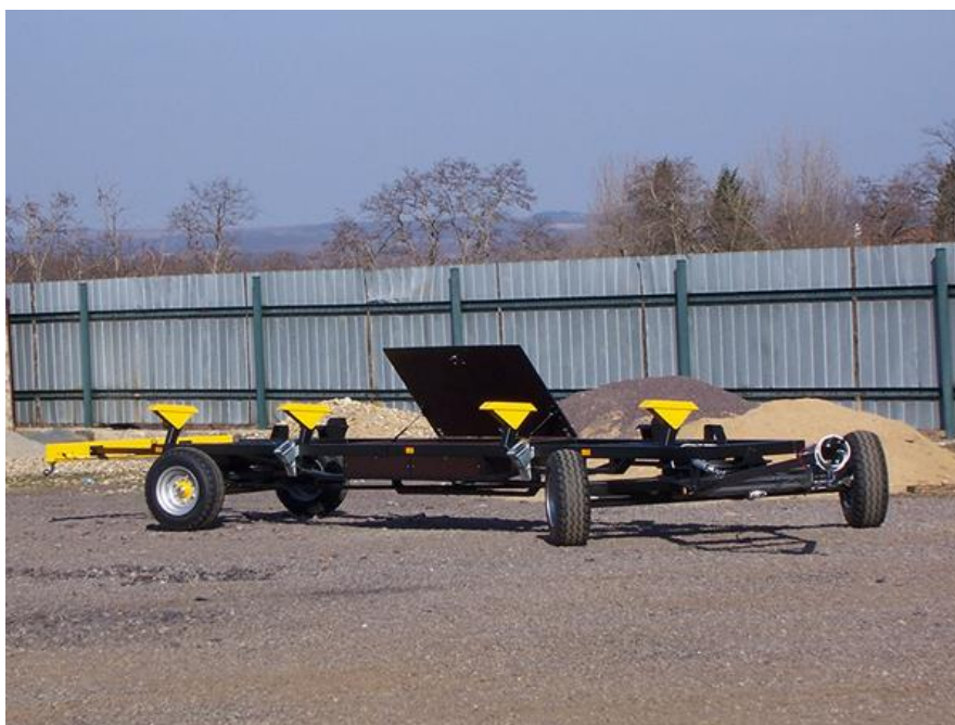
Obrázek 23: Podvozek s říditelnými nápravami (agrotech-hejtmanek.cz)
