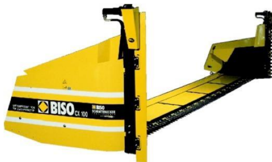
Obrázek 10: Přídavný řepkový adaptér BISO (biso.sk)
