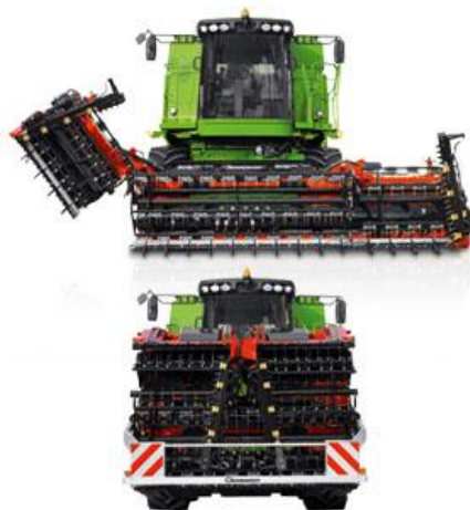
Obrázek 24: Různé druhy skládání sklízecích ústrojí
