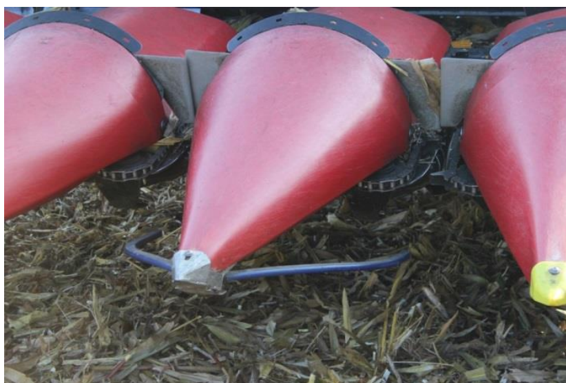
Obrázek 30: Systém navádění firmy TrueSight (mechanizaceweb.cz)
