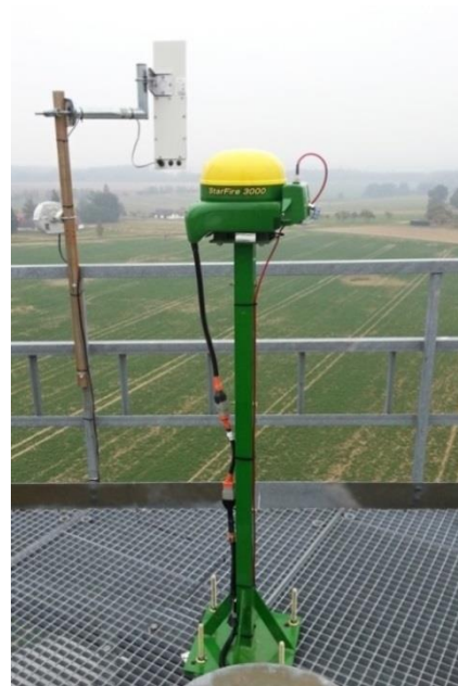
Obrázek 29: Stanice RTK firmy John Deere (danhel.cz)
