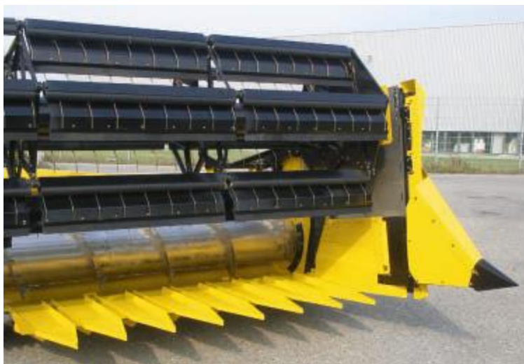
Obrázek 11: Přestavba obilního adaptéru na slunečnici (biso.sk)
