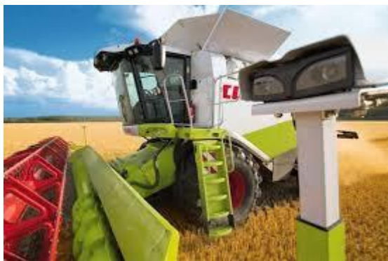
Obrázek 26: Laser Pilot firmy Claas (claasharvestcentre.co.nz)
