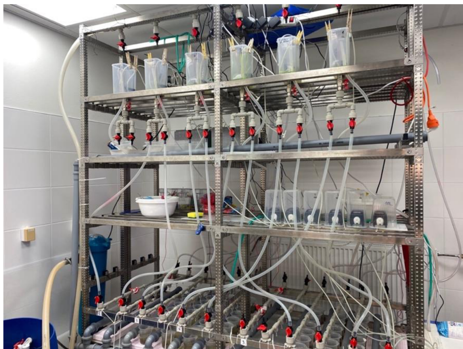
Obrázek 1 ukazuje pulzně průtočný systém (PFT) v malakologické laboratoři na Katedře zoologie a rybářství České zemědělské univerzity v Praze.
