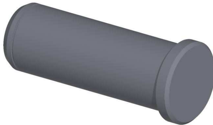
Obr. 13 Model otočného čepu plošiny
