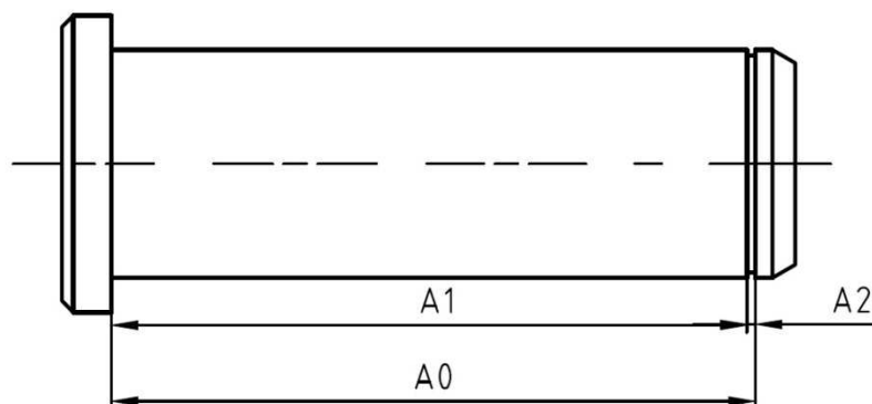
Obr. 14 Schéma tolerančního obvodu
