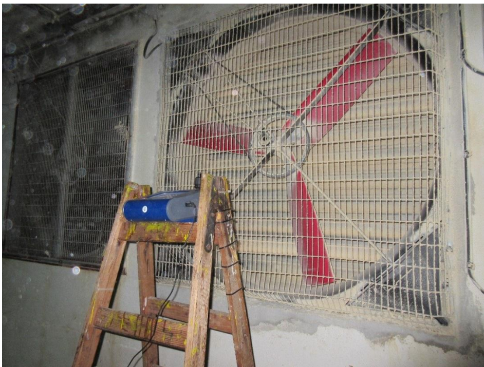
Obrázek 12 – Umístění přístroje DUST TRAK II č. 1 před ventilátorem, Zdroj: Autor
