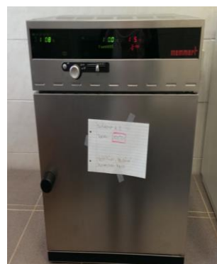
Obrázek 9 Sušárna Memmert UNB 400 [vlastní zpracování]
