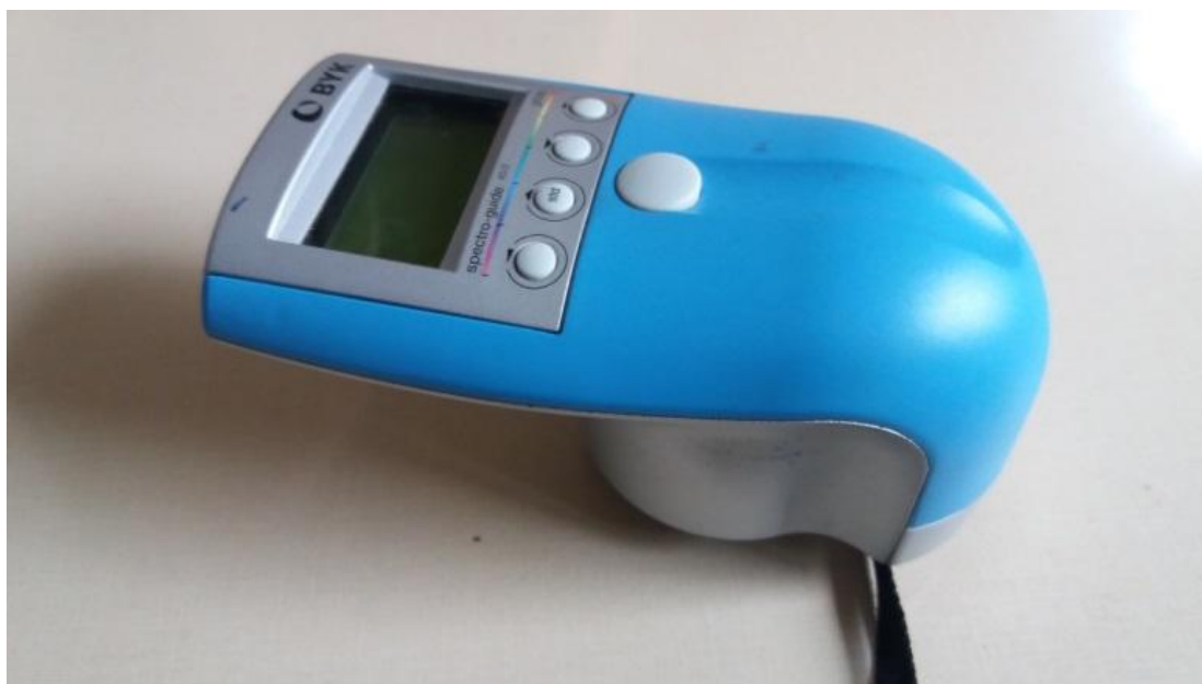
Obr. 3: Spektrofotometr BYK Spectro-Guide 45/0 Gloss (Vaněk 2016, vlastní foto)
