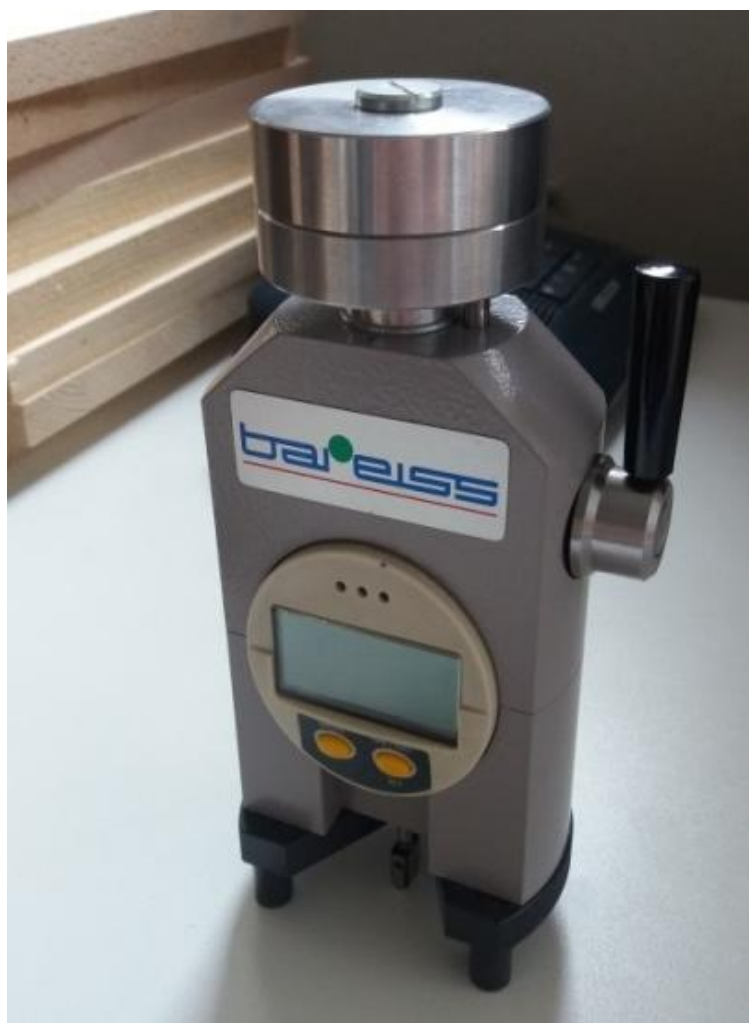
Obr. 5: Mikrotvrdoměr – Buchholtz FL – 2000 H (Vaněk 2016, vlastní foto)
