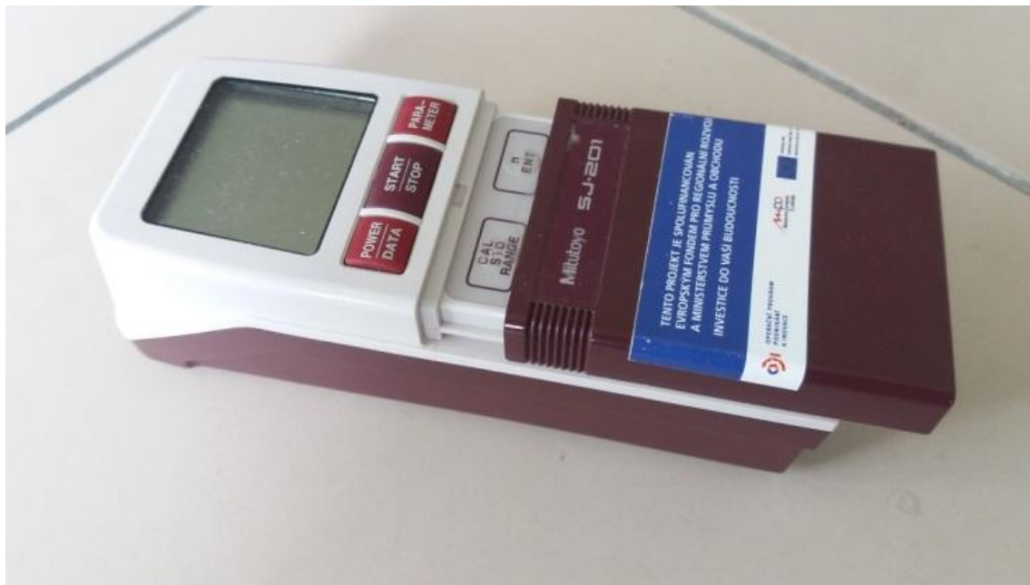
Obr. 2: Drsnoměr - SJ – 201P MITUTOYO (Vaněk 2016, vlastní foto)
