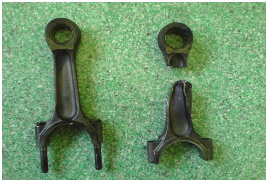
Obr. 40 Nepoškozená a přetržená ojnice - foto z vlastního zdroje
