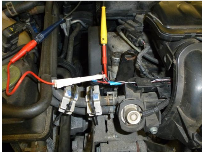
Obr. 49 Připojení adaptérového vedení mezi konektorový spoj vačkového hřídele - foto z vlastního zdroje
