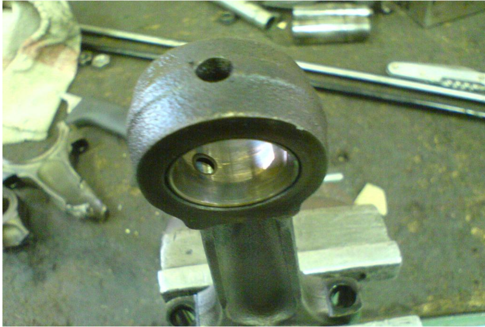
Obr. 41 Pootočené pouzdro v oku ojnice - foto z vlastního zdroje
