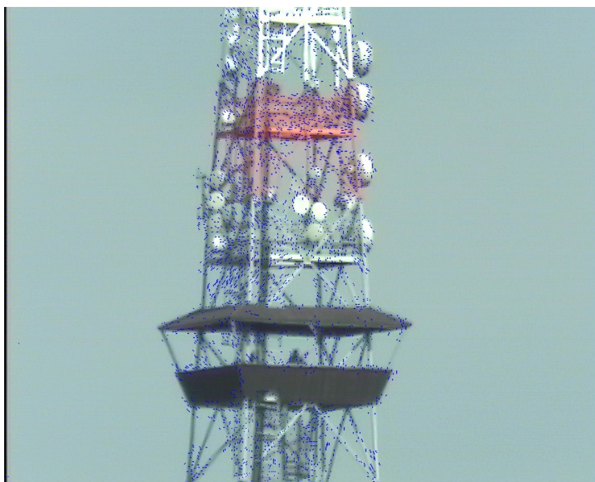
Obrázek 4.2: Optický tok, posuny bodů jsou vyznačeny modře.
