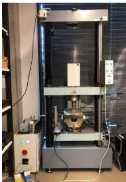
Obr. 26 Trhací zařízení TIRA Test 2300
