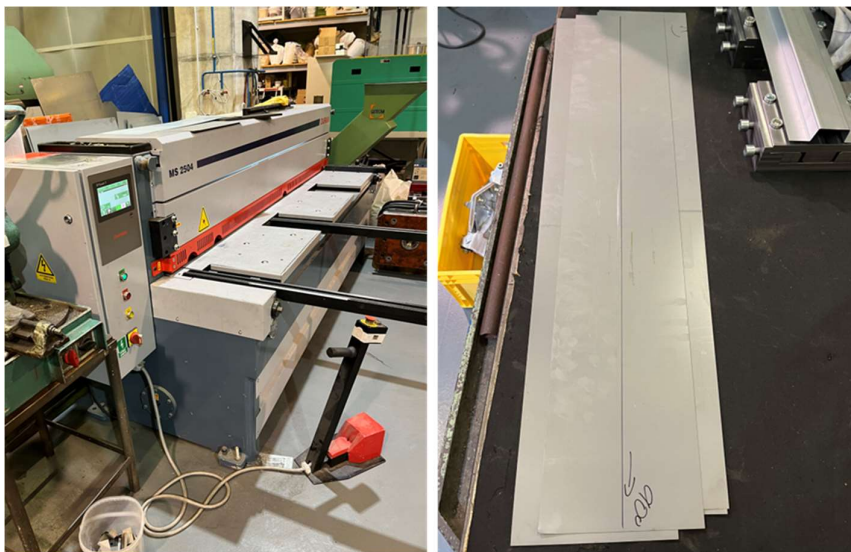
Obr. 28 Mechanické nůžky MS2004 (vlevo) a nastříhané pásy plechů (vpravo)
