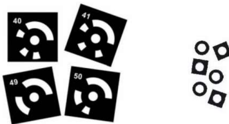
Obr. 20 Kódované (vlevo) a nekódované (vpravo) body [23]
