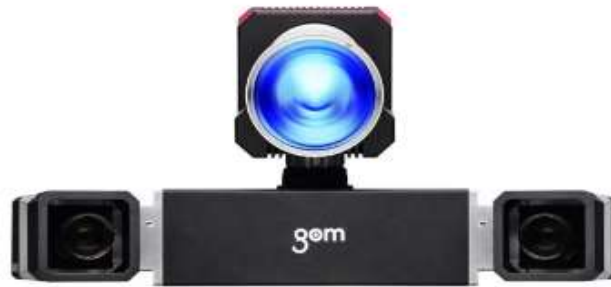
Obr. 24 Systém kamer ARAMIS [27]
